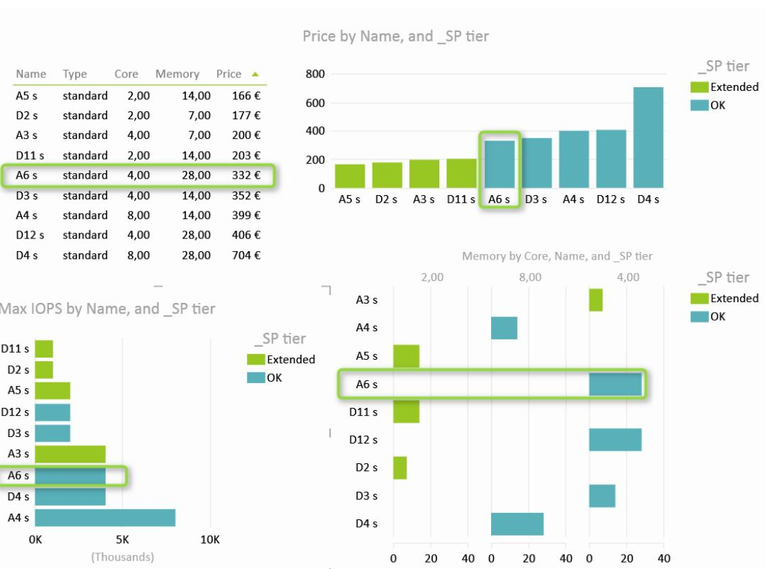
A ce stade, nous notons l'absence d'une configuration avec 4 coeurs et 14 Go dans la série A. La nouvelle configuration D3 remplit ce manque mais est plus chère que la configuration A6 (que nous retenons donc).
